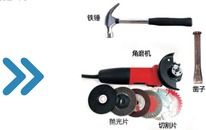
(图5：剥除玻璃钢常用工具)
