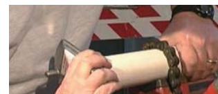
2.管道倒角10-15°，清理边角碎屑
