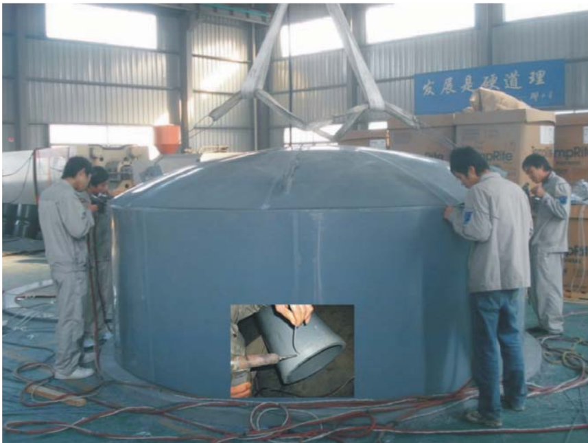
(图11: PVC-C、PVC-U等产品的焊接要掌握好“四度”)
